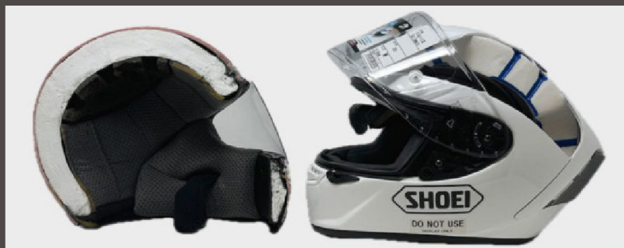
A gauche, un Shoei sportif fibre des années 90, à droite, un X Spirit 3 de 2020 : l'EPS reste de mise mais la densité, l'épaisseur et les formes ont évolué.
