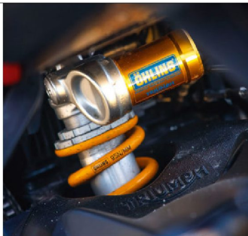
Repris à la Street Triple 765 RS, l'amortisseur Öhlins participe pour beaucoup de la réussite dynamique et esthétique de la Street RX.
