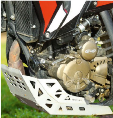
Le moteur de la Rieju est bien protégé par le sabot ACD du kit R proposé par la marque en plus de pneus Michelin Tracker.
