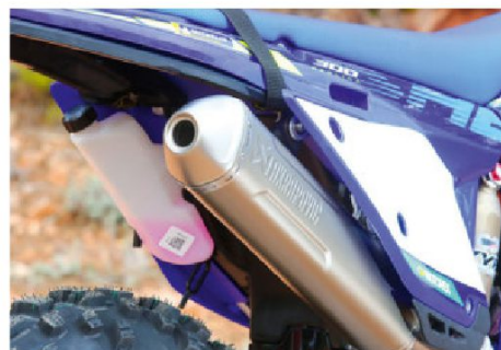
Sangles de traction AV/AR, selle anti-dérapante, silencieux Akrapovic long et vase d'expansion, tout ce qu'il faut pour hard-endurer.
