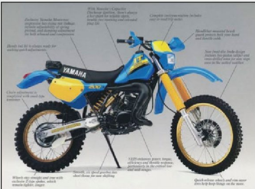
La IT 200 en 86 amenait un coup de neuf. Look radical, frein avant à disque et suspension monocross. Superbe.
